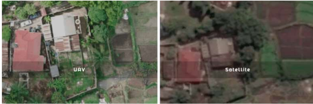
Gambar 2.3 Perbandingan antara hasil tangkapan drone dan satelit (Satish, 2022).
